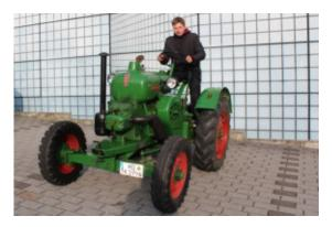
Mit einem einmaligen Fahrzeug - einem Allgeier R18, Bj. 1949 mit einem 18 PS starken Einzylindermotor - und das besondere der Motor trägt die Motornummer 01 - ein echt einmaliges Stück.
